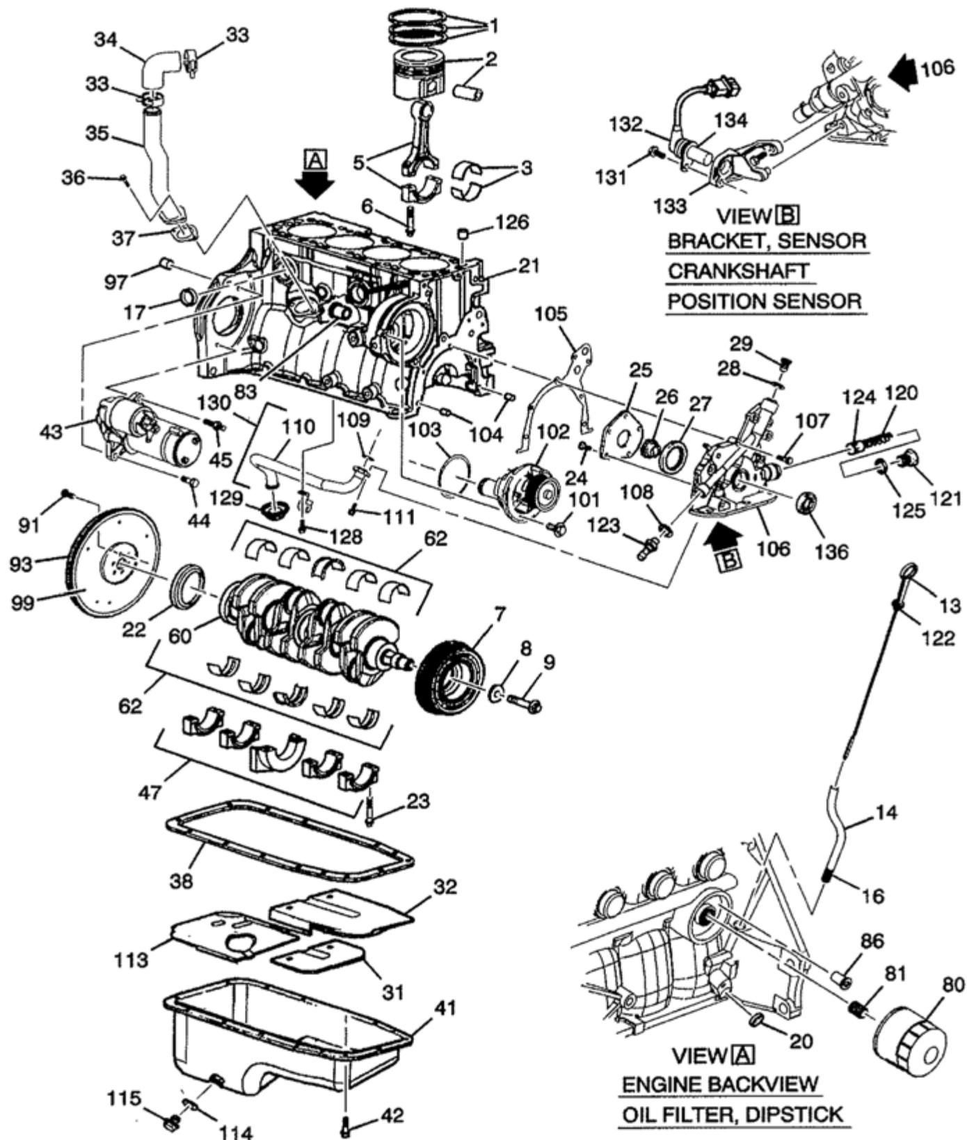
**ENGINE GM 1.6L - ENGINE COMPONENT BREAKDOWN ILLUSTRATION 1
