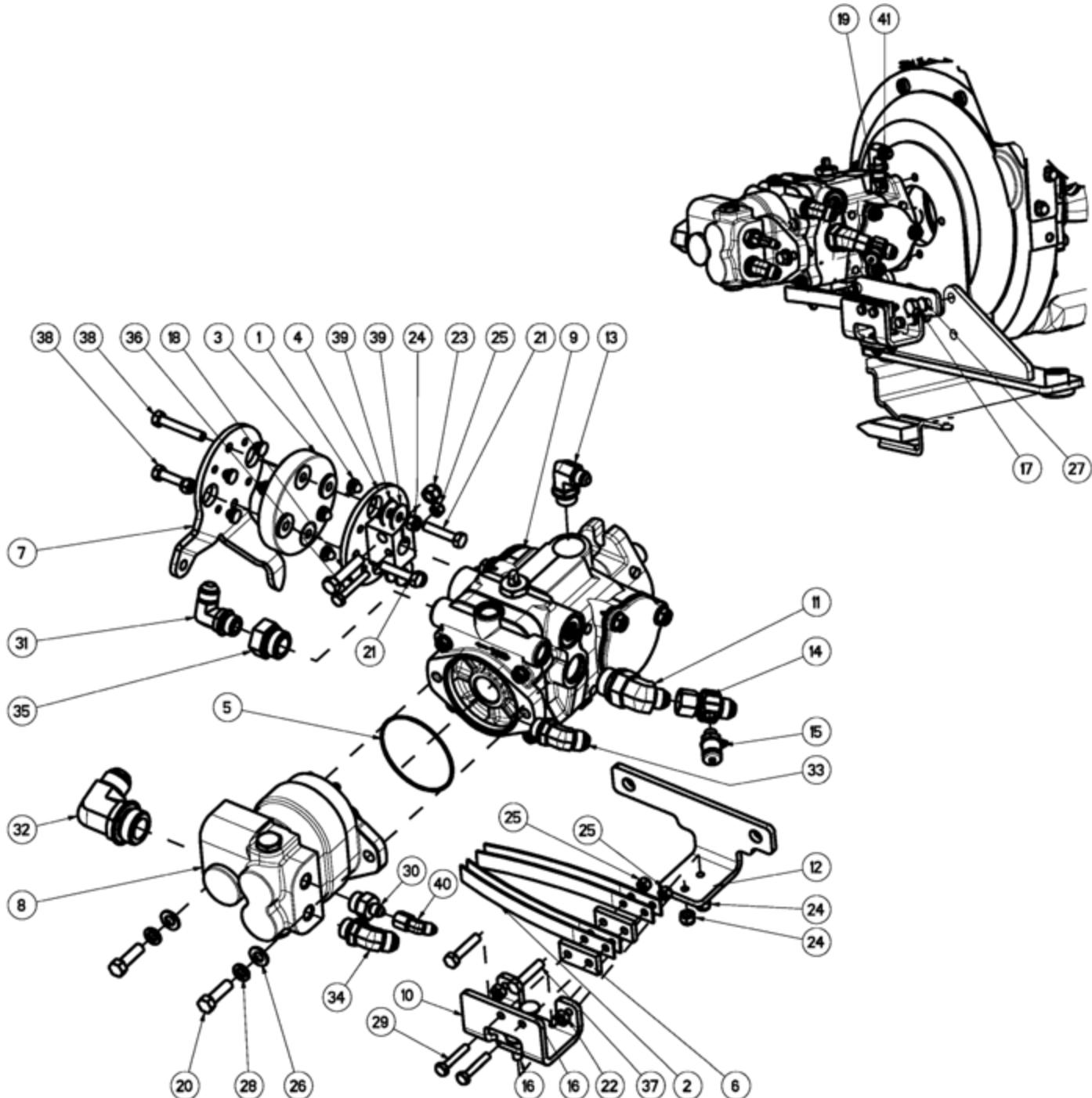
**ENGINE GM 1.6L - HYDRAULIC PUMP DETAILS**
